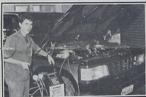
Nova máquina: ar condicionado do carro reconstituído em 20 minutos
